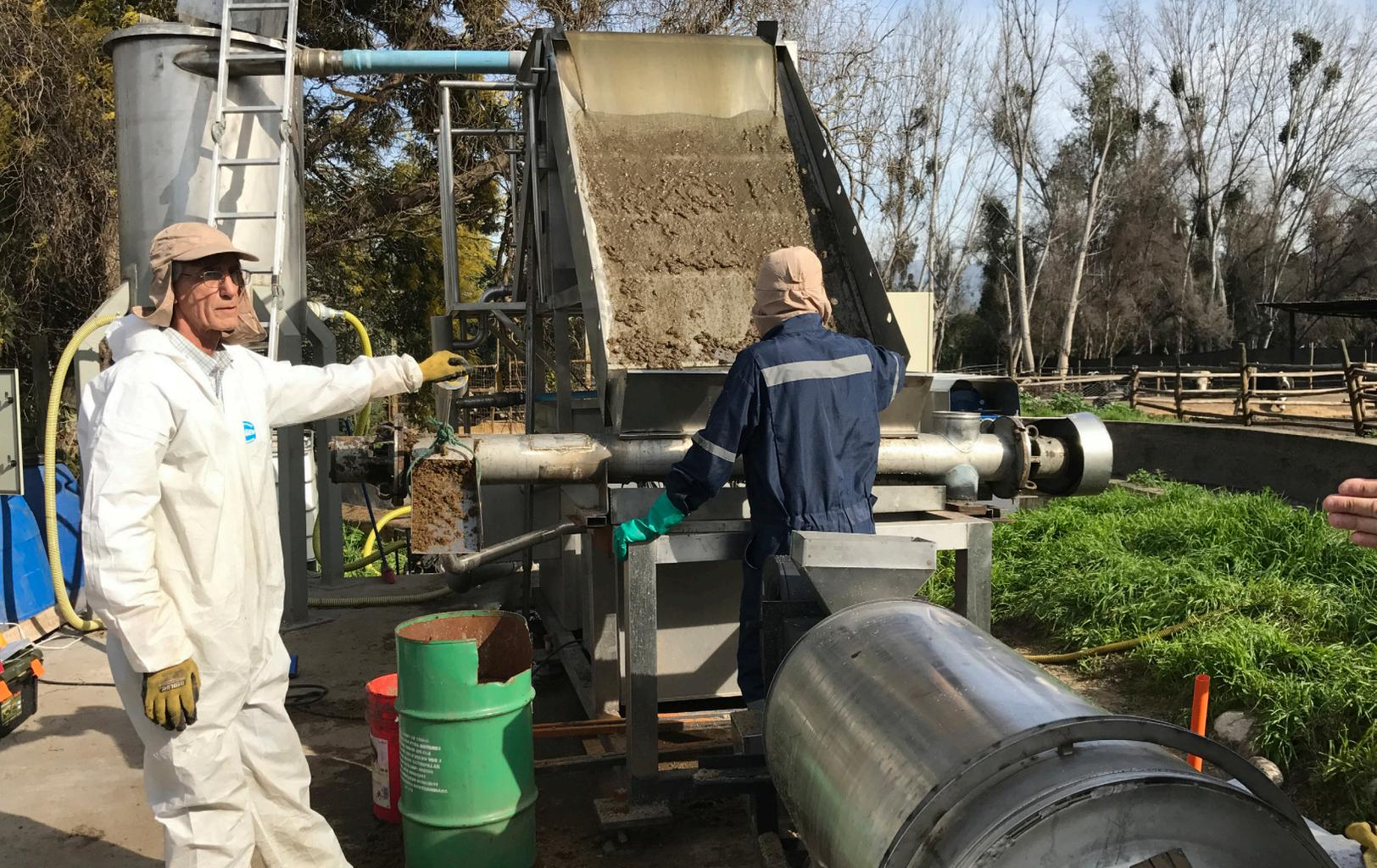
Equipo DoClean en la planta de producción de pellets de lignina.
